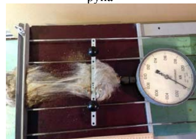
в) початок процесу розтягування руна
