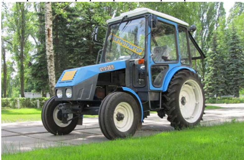
Рисунок 3 – Дослідний зразок електротрактора на базі трактора ХТЗ – 2511
