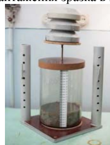
ж) встановлення вантажу ( G_i )
