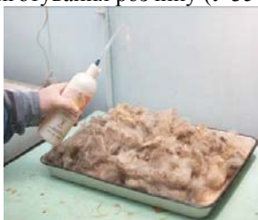
в) зволоження зразка вовни (до W_i )
