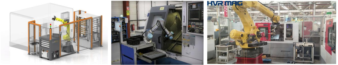
Рис.1.1. Однопозиційна роботизована комірка: робот + верстат
