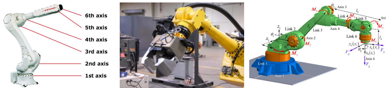
Рис.5.1. Будова промислового робота-маніпулятора
