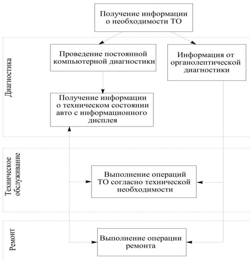
Рисунок 5 Получение диагностической информации о состоянии узлов, систем и агрегатов автомобиля при интеллектуальной системе (ИС) ТО и Р
