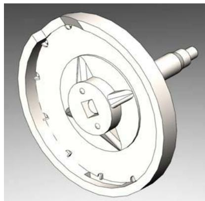
Рисунок 2 – Тривимірна модель запропонованого пневмомеханічного висівного апарата
