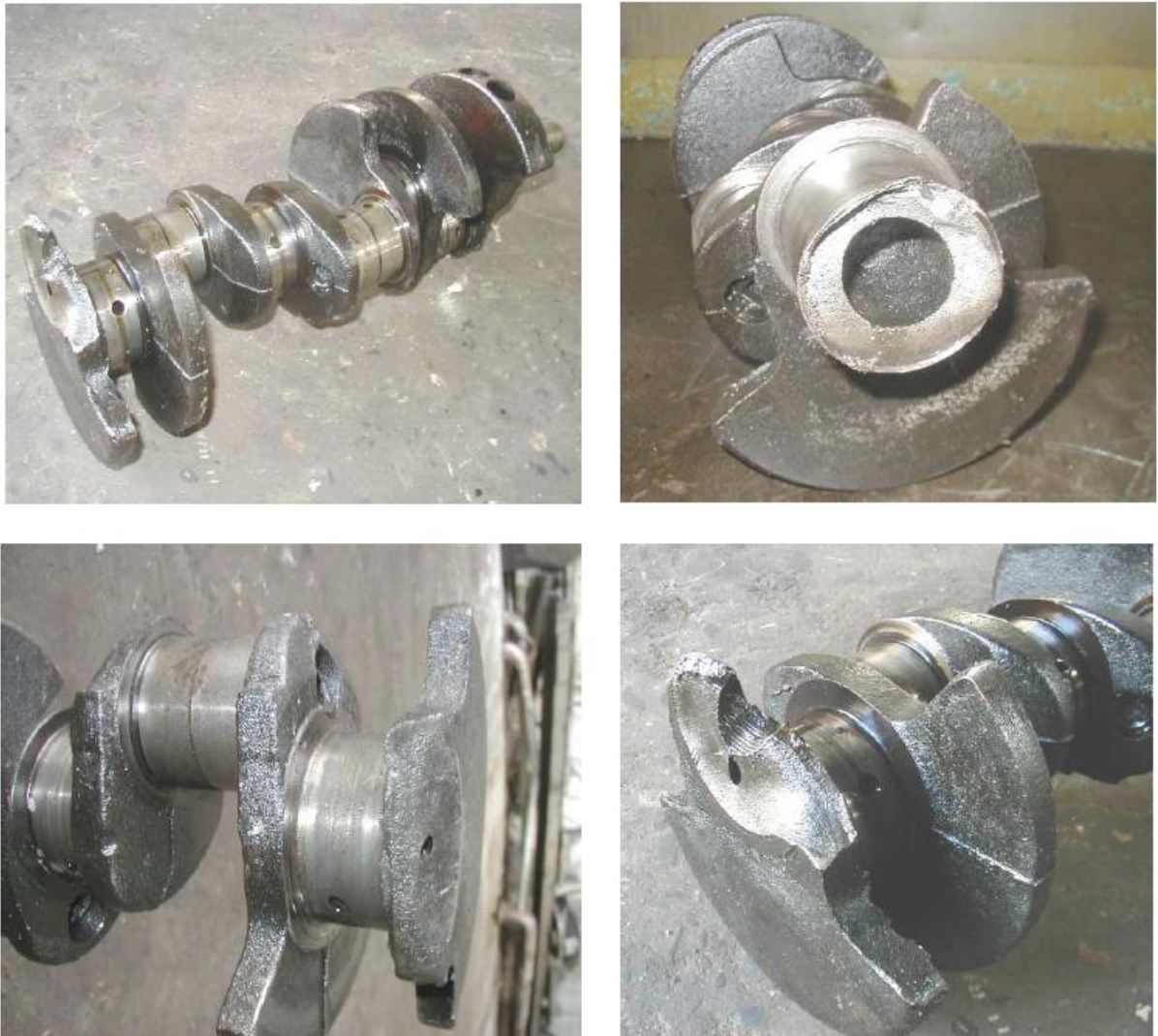
Рисунок 2.7 - Характерні види відмов та поломок колінчастих валів двигунів
