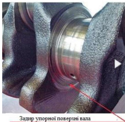
Рисунок 2.5 – Задирання на поверхні колінчастого валу [15].
