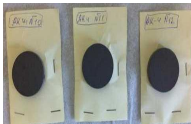
а) б) Рисунок 3.10- Обробка а) та зовнішній вигляд б) зразків з сплаву АК 4-1 для випробування на зносостійкість
