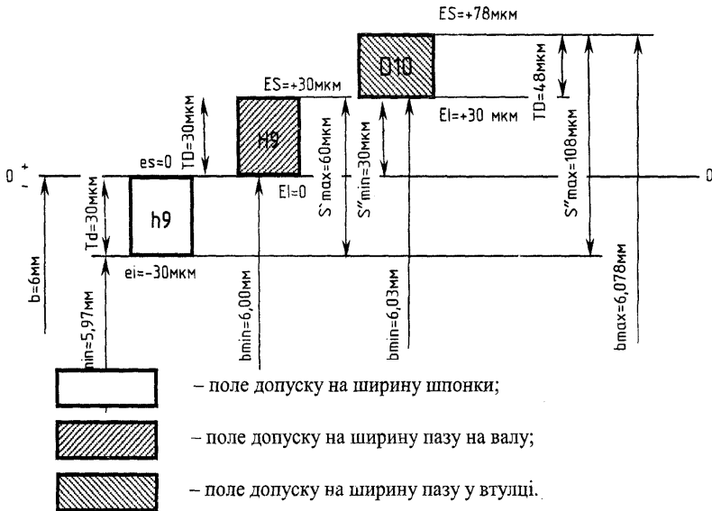
Рис. 4.1 – Схема розташування полів допусків на бічну поверхню деталей з'єднання призматичною шпонкою
