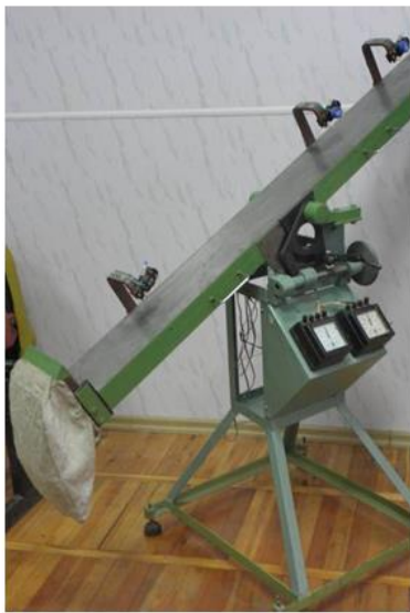
Рис. 3.18. Загальний вигляд та схема лабораторної установки для визначення коефіцієнта тертя методом скатної площини (за В.О. Желіговським).
