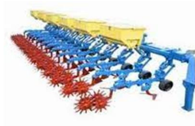
Рис. 3.4. Культиватор УСМК-5,4 (з підживленням рослин)
