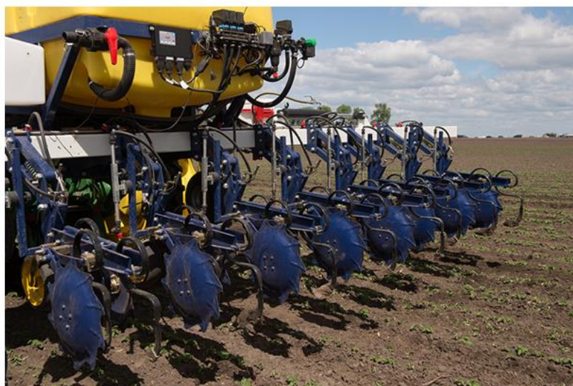
Рис. 3.8. Просапний культиватор A3Tech FIGHTER
