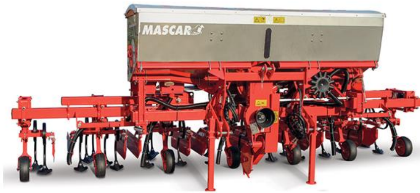
Рис. 3.3. Міжрядні просапний культиватор GALILEO
