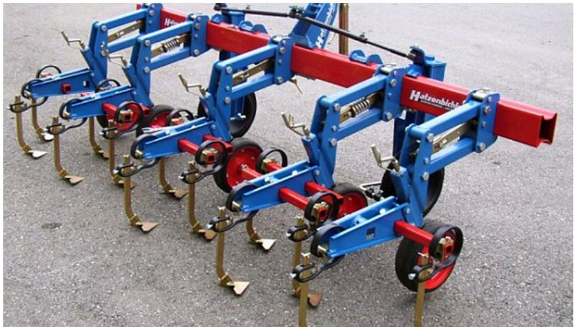
Рис. 3.6. Культиватор просапний (Hatzenbihler)
