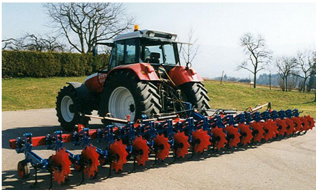
Рис. 3.7. Просапний культиватор "SKR" (Hatzenbichler)
