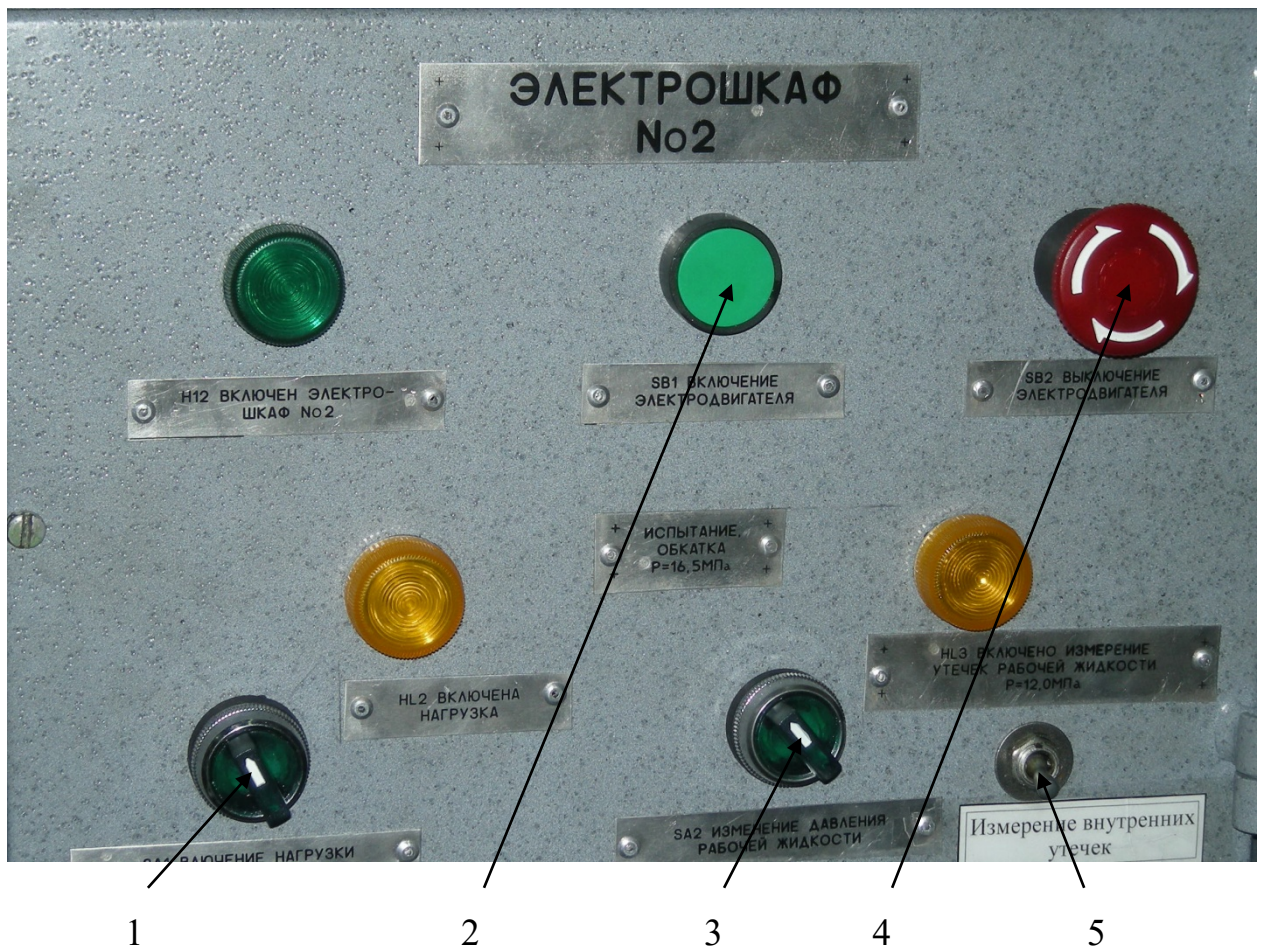
Рис. 3.2.2.5 Конструктивне виконання панелі електрошкафа
