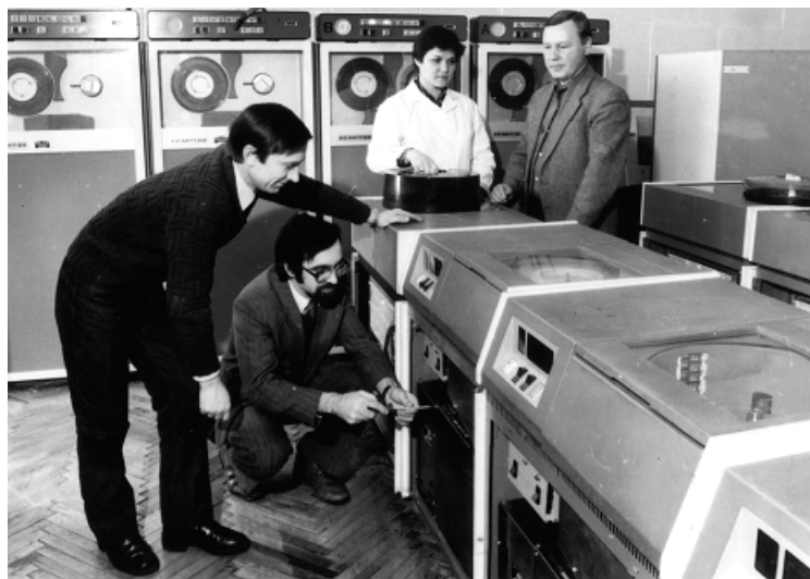
Рисунок 21. Ремонт НЗМД ЄС-5061 ЕОМ ЄС 1040, 1987.
