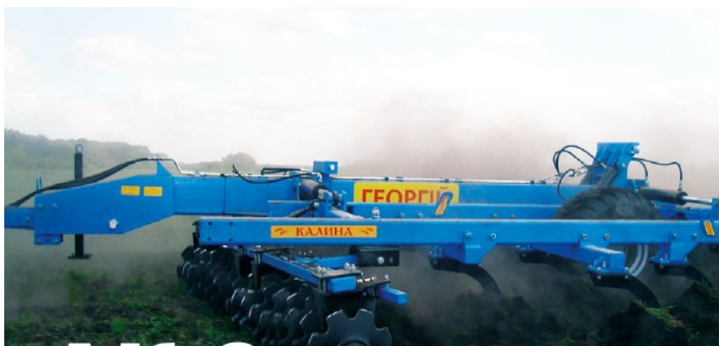
Рисунок 3.1 – Агрегат комбінований АК-6 «Георгій»
