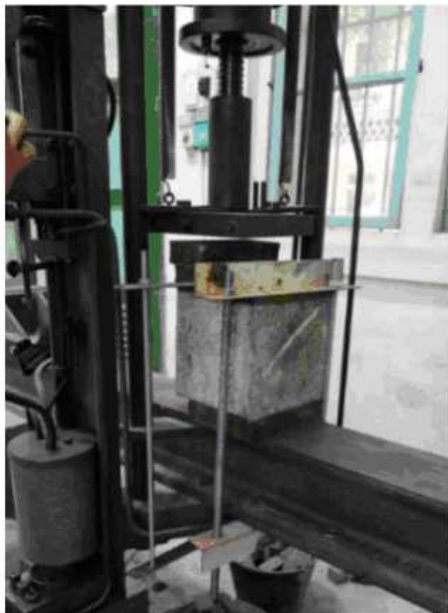
Рисунок 6. Загальний вигляд зразки та схема випробування на зсув При проведенню дослідженні використано метод випробування Джохла для визначення міцності міжфазного зсуву між шарами бетону (рисунок 6). Моменти в площині зсуву, менші або рівні граничному моменту вигину площини
