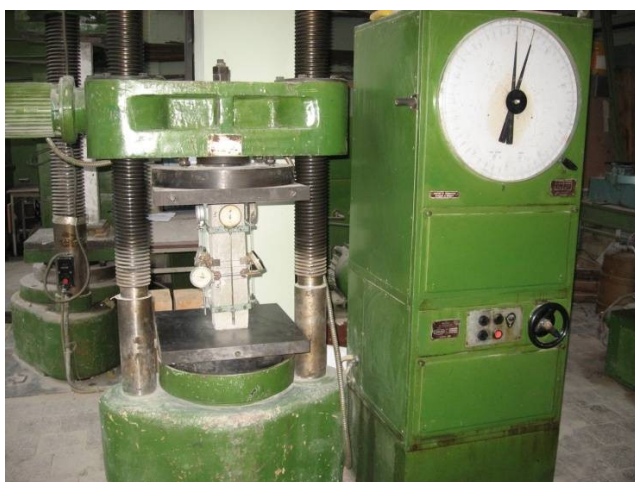
Рисунок 19 – Випробування бетонних призм
