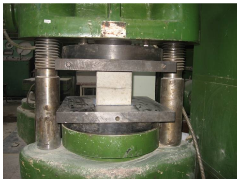
Рисунок 18 – Випробування бетонних кубів
