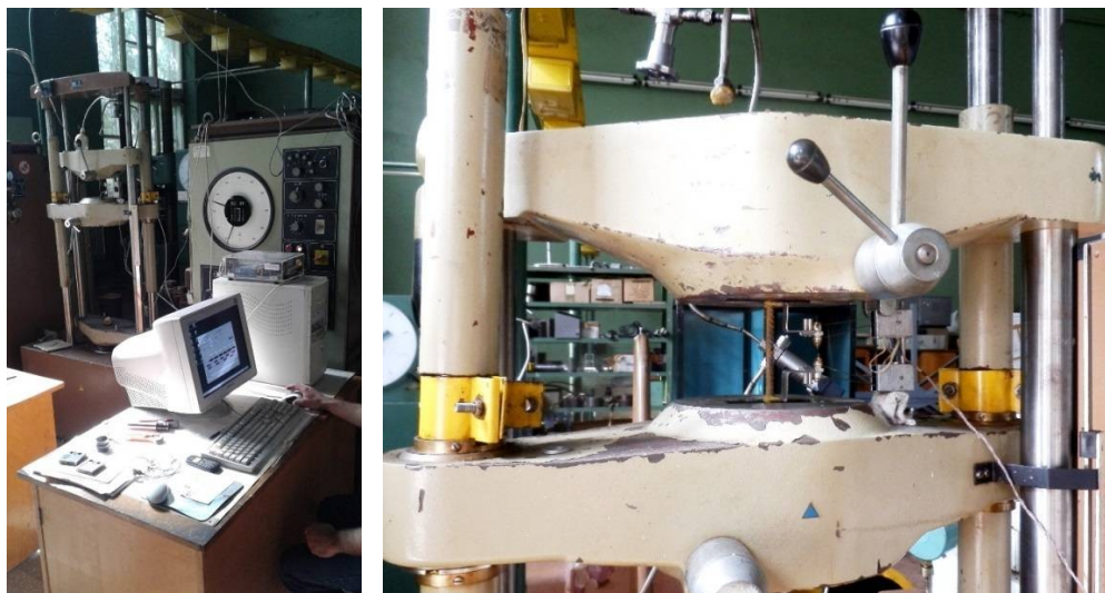
Рисунок 20 – Випробування зразків арматури на розривній машині СТМ-100
