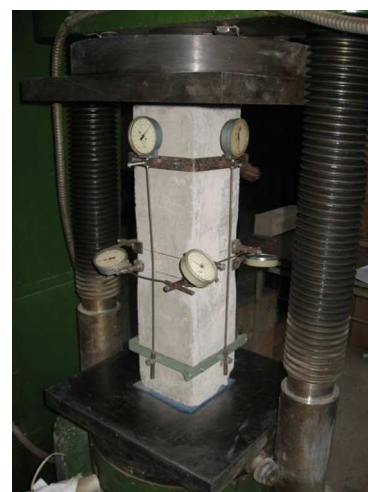
Рисунок 19 – Випробування бетонних призм
