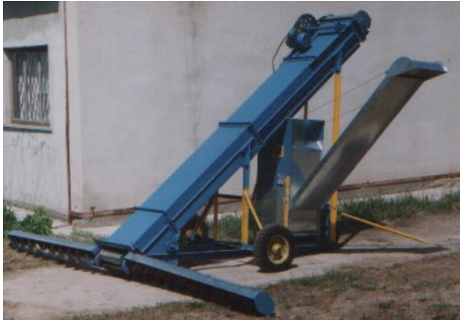
Рис. 2.9. Загальний вигляд інерційного прямоточного сепаратора МЗП-10
