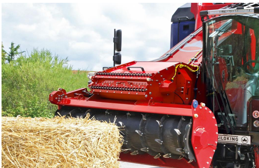
Рис. 2.10. Шнекова фреза та подрібнювач соломи комбайнів SILOKING SelfLine
