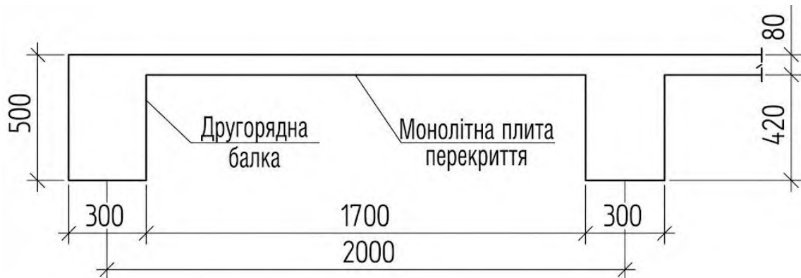
Рис. 2.3 Поперечний переріз перекриття
