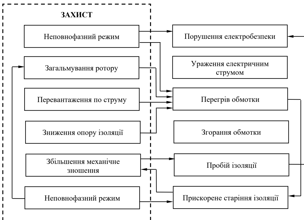
Рисунок 1.2 – Основні функціональні зв'язки при аварійних режимах електродвигунів
