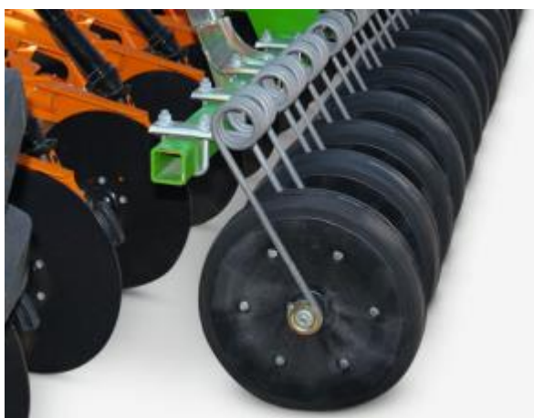
Рис. 4.8 Прикочувальна система Amazone
