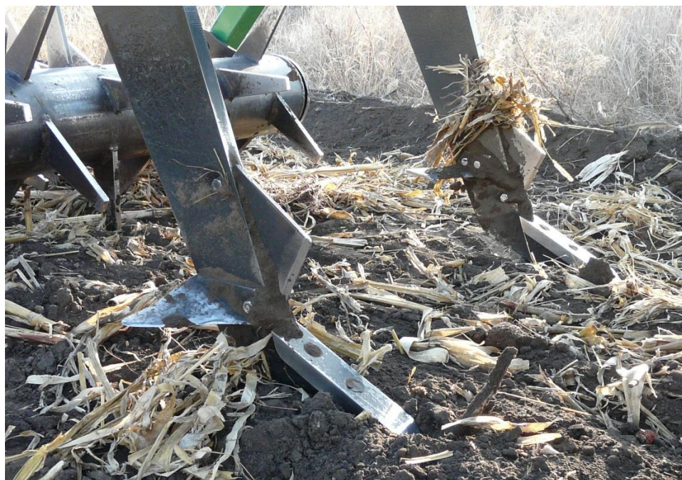
Рис. 13. Загальний вигляд вдосконалених крил типу хвіст дельфіна
