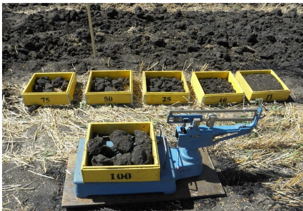
Рис. 14. Загальний вигляд решітного класифікатора для розділення обробленого ґрунту на фракції за розміром
