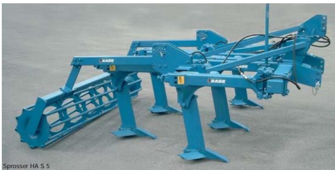
Рис. 10. Загальний вигляд чизельного глибокорозпушувача «SPROSSER» виробника «RABE» (Німеччина)
