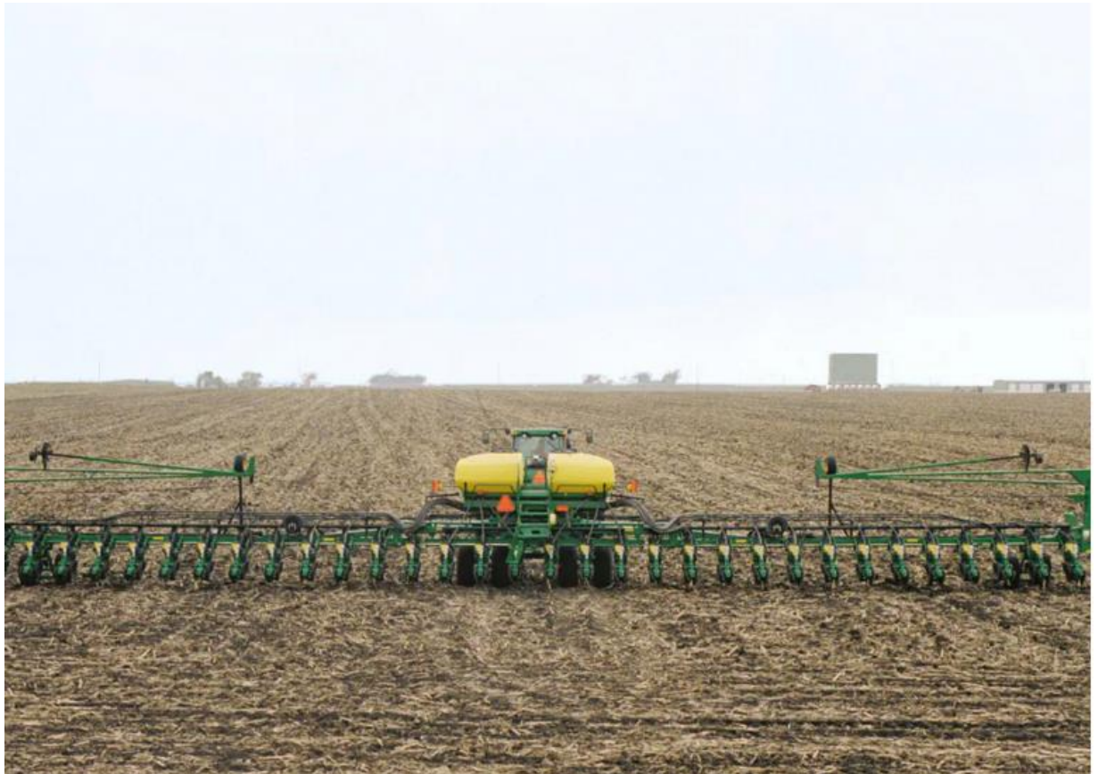
Рис. 3.3. Сівалка для прямої сівби марки John Deere DB55.
