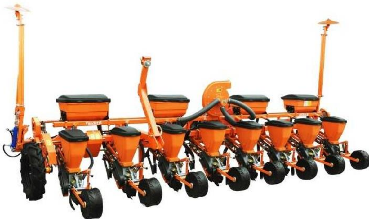
Рис. 3.5. Схема запропонованої пневматичної сівалки марки Веста 8 (УПС-8).
