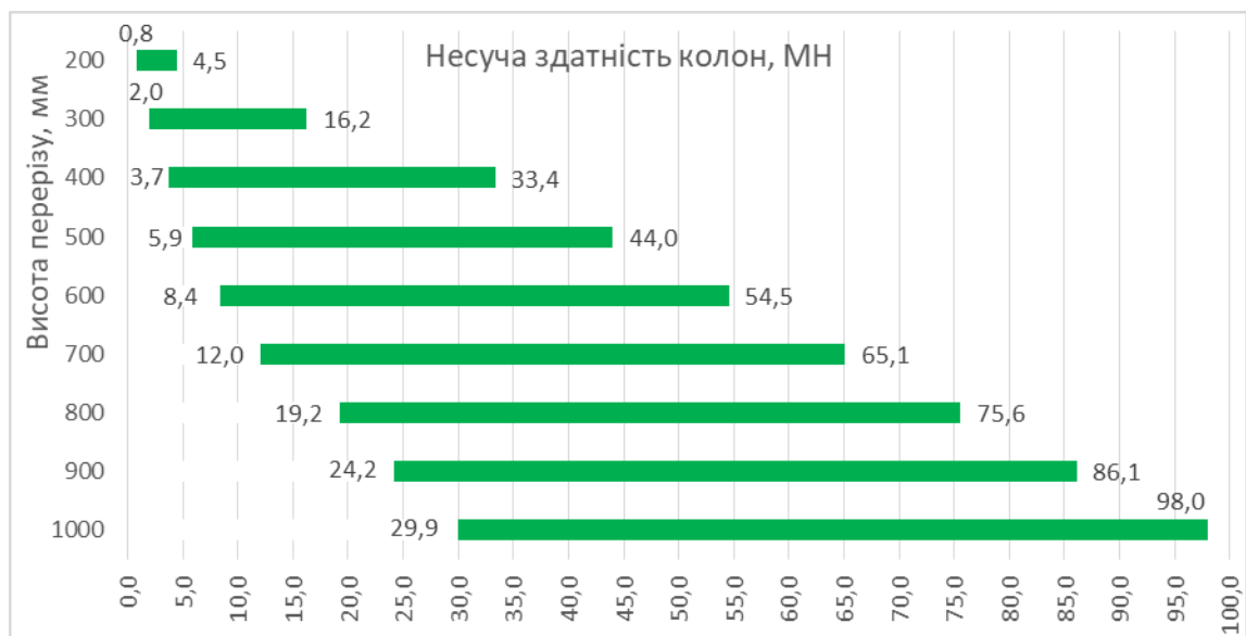
Рис. 4.6 Межі несучої здатності колон залежно від габаритів перерізу
