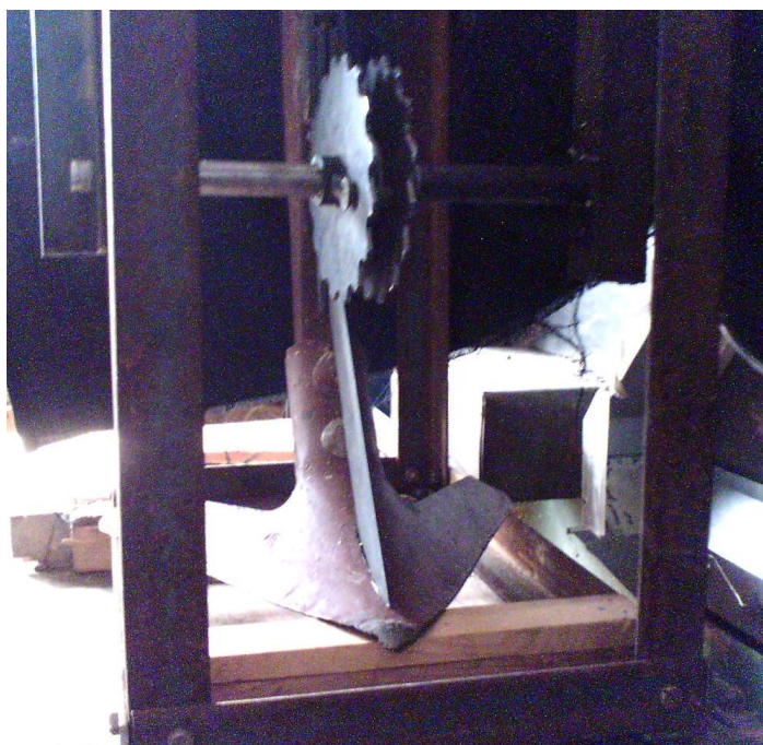
Рис. 3.4. Загальний вигляд пристосування для дослідження дискового очисника: а – вид з боку; б – вид з переду.
