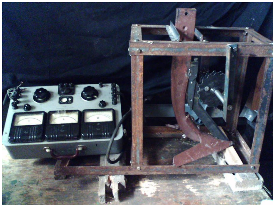
Рис 3.2. Загальний вигляд дослідного комплексу з спеціальним вимірювальним пристроєм типу К50
