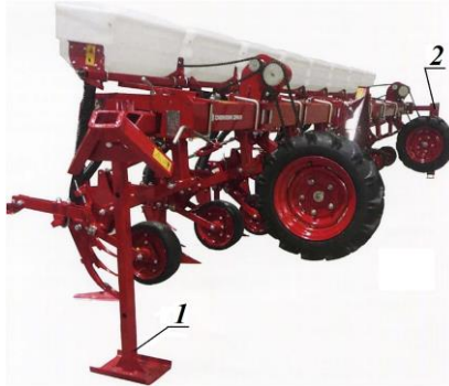
Рис. 6. Зберігання з транспортирним пристроєм: 1 – стійка транспортного пристрою; 2 – опора
