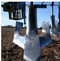
Рис. 2.41. Стерньовий культиватор LEMKEN «Kristall»: а – будова культиватора; б – стрілочасті лапи «Три-Мікс»
