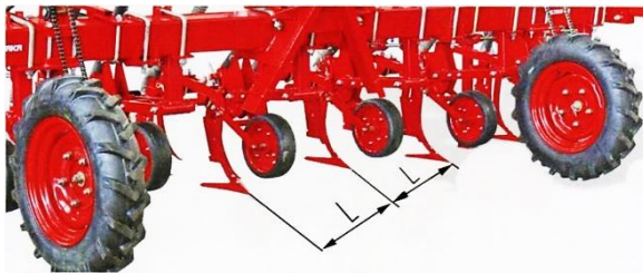
Рис. 4.3.19. Розміщення секцій робочих органів культиватора
