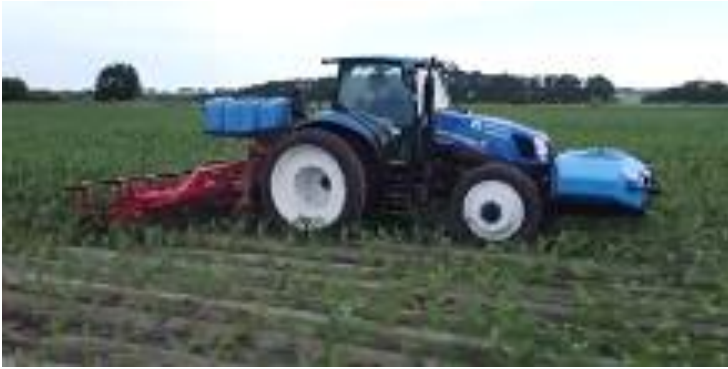
Рис. 2.83 Внесення рідких мінеральних добрив або гербіцидів безпосередньо в рядки рослин культиватором STEKETEE
