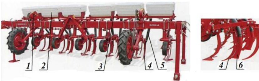
Рис. 4.3.14. Пристрій для підживлення просапних культур: 1 – механізм передач; 2 – туковисівні апарати; 3 – шарніри; 4 – лапи з трубкою; 5 – тукопроводи; 6 – розтруб ножа
