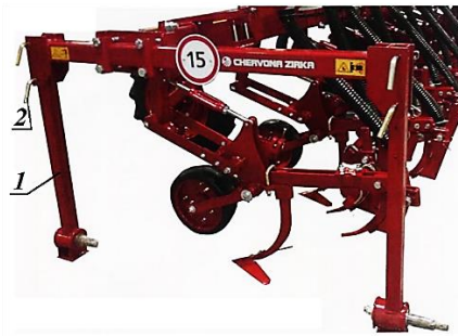
Рис. 4.3.60. Переобладнання культиватора в транспортне положення: 1 – стійка; 2 - штир-фіксатор
