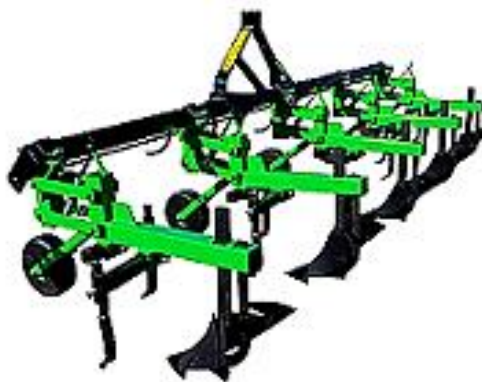
Рис. 2.90 Просапный культиватор Vomet: а – трёхрядный; б – п'ятирядный
