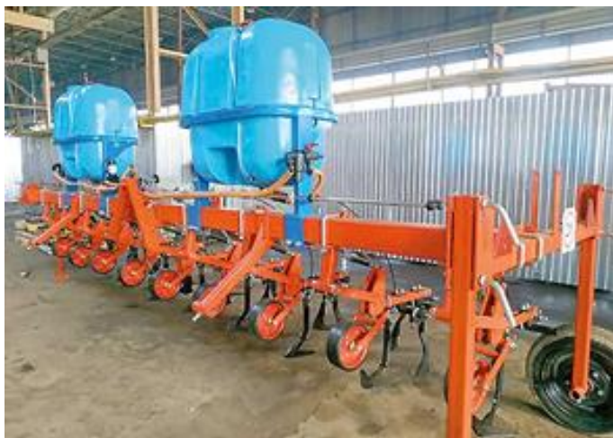
Рис. 2.71 Культиватор-підживлювач просапний КПР-5,6 Поділля Vermont 560 із пристроєм для внесення рідких добрив
