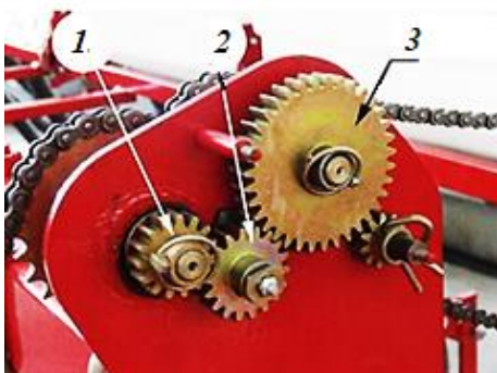
Рис. 4.33 – Перевірка налагодження механізму передач: 1, 2, 3 – зубчасті колеса
