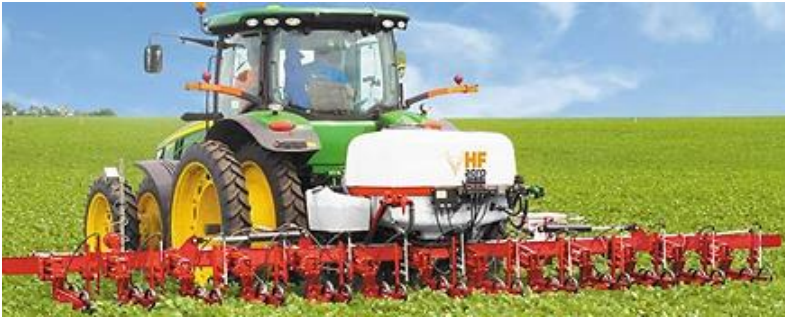
Рис. 2.74 Культиватор SANTIM з системою внесення рідких добрив і засобів захисту рослин
