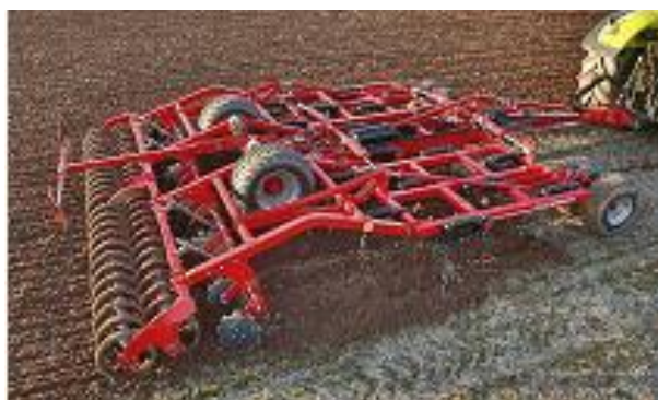
Рис. 2.61 Культиватор HORSCH Terrano GX: а – 3-х рядний; б – 4-х рядний
