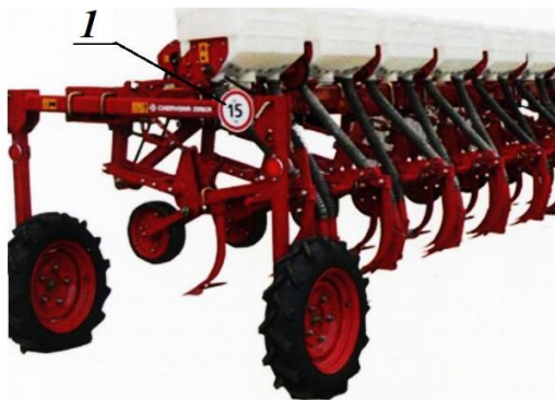
Рис. 4.3.18. Культиватор в положенні далекого транспортування: 1 – знак обмеження швидкості
