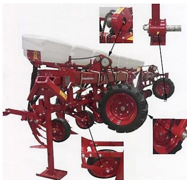
Рис. 3. Схема змащення культиватора
