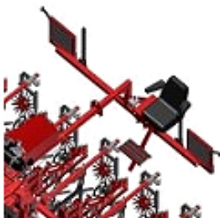
Рис. 2.81 Міжрядний культиватор EC-Weeder: а – загальний вигляд; б – автоматична система на основі камери IC-Light; в – ручне управління; г – підрулювальна рама
