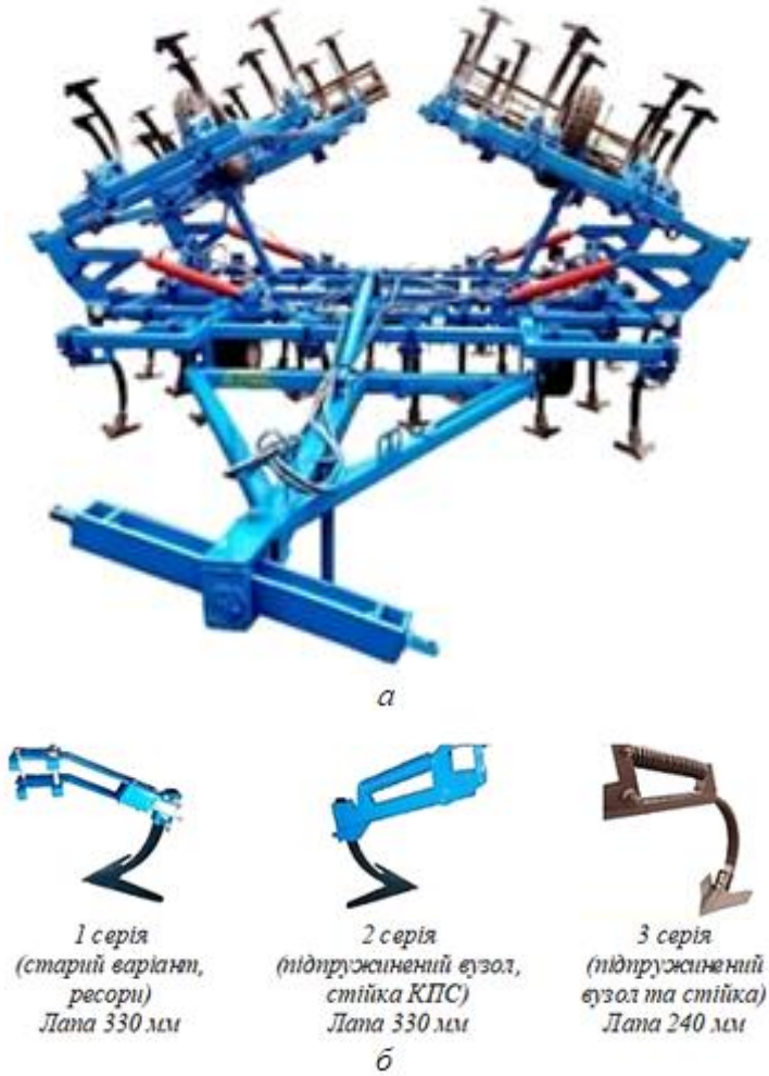
Рис. 2.14. Культиватор паровий причіпний КПП-8,2: а – загальний вигляд; б – робочі органи
