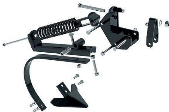
Рис.2.33. Культиватор причіпний КПС-9 ПМ: а – загальний вигляд; б – робочий орган
