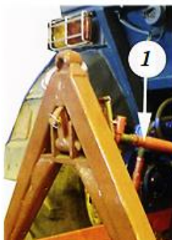
Рис. 4.3.35. Регулювання верхньої тяги начіпки трактора: 1 – верхня (центральна) тяга
