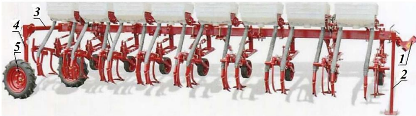
Рис. 4.3.13. Транспортний пристрій: 1 – сниця; 2 – опори; 3 – брус; 4 – стійка; 5 – колесо
