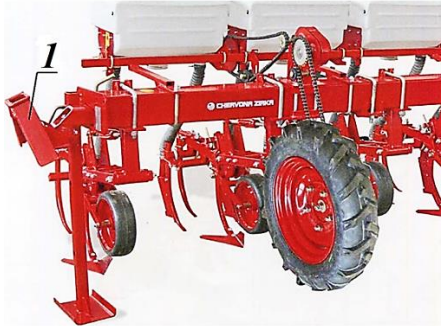
Рис. 4.3.56. Пристрій для транспортування культиватора: 1 – сниця
