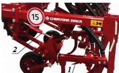
Рис.4.3.27.Встановлення гряділя секції: 1 – гряділь; 2 – стяжна гайка
