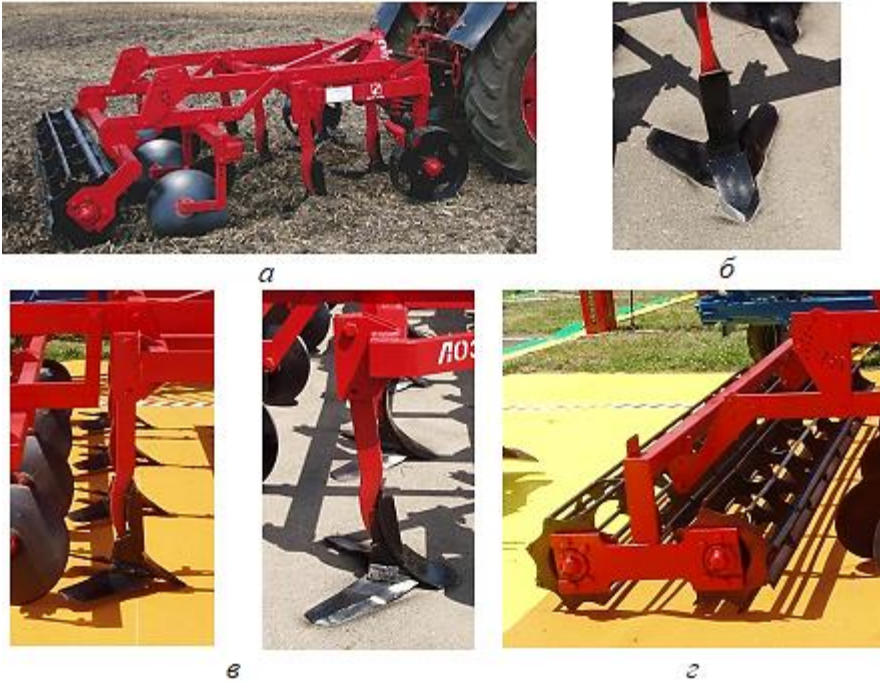
Рис. 2.40. Особливості конструкції стерньового лемішно-дискового культиватора Шилінг: а – регулювання глибини обробки; б – крильчасті леміші; в – регулювання кута нахилу лап; г – здвоєний коток
