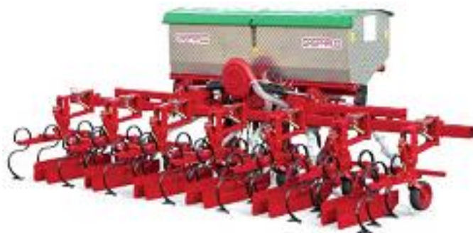
Рис. 2.85 Просапний культиватор Gaspardo: а – HL з жорсткою рамою; б – HP з складною рамою
