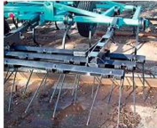
Рис. 2.28. Культиватор серії «К» Краснянське СП «Агромаш»: а – загальний вигляд; б – стрільчаста лапа; в – пружини борони
