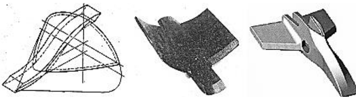
Рис. 3.24. Робочі органи культиваторів виконані за формою проміжного тіла в ґрунті
