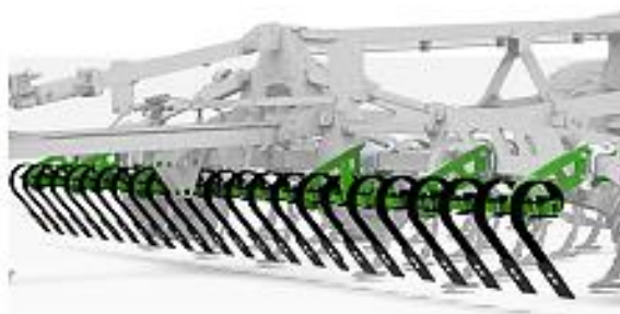
Рис. 2.51. Додаткове обладнання культиватора: а – ножовий коток; б – вирівнювачі Crushboard
