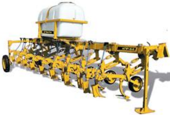
Рис. 2.75 Культиватор-підживлювач КРН-5,6-04 із системою внесення рідких добрив
