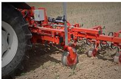
Рис. 2.86 Просапний культиватор GASPARDO с системой GUIDE INTELLIGENTE:
