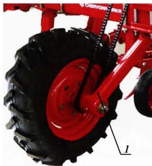
Рис. 4.3.22. Опорно-приводне колесо культиватора: 1 – кронштейн
