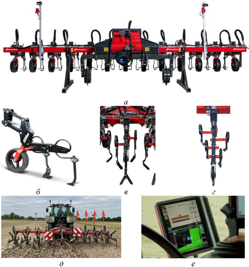
Рис. 2.88 Міжрядний культиватор Kverneland Onyx: а – загальний вигляд; б – секція культиватора; в – стійка з А-подібними плоскорізальними і L-подібними бічними лезами-бритвами; г – S-подібні SC-стійки; д – автоматичний підйом секцій; е – комп’ютерний термінал
