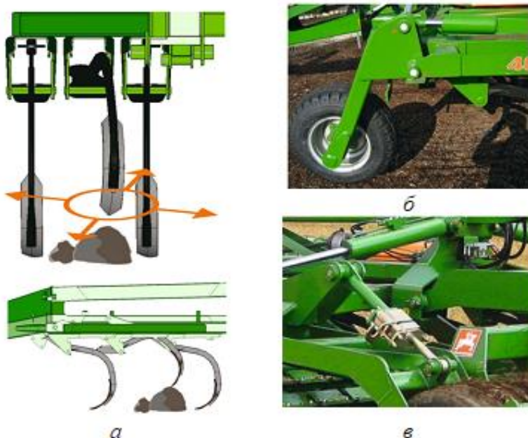
Рис. 2.55. Обладнання культиватора Centaur Special: а – лапи з пружинним блоком запобіжником; б – копіювальне колесо; в – механізм регулювання глибини
