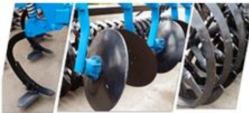
Рис. 2.19. Агрегат комбінований ґрунтообробний АКГ-3: а – загальний вигляд; б – робочі органи
