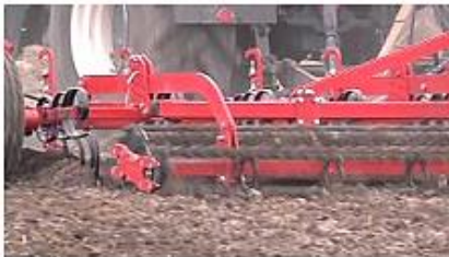
Рис. 2.22. Культиватор КПО-8 «Червонец»: а – загальний вигляд культиватора; б – робота культиватора; в – S-подібні пружинні стійки культиватора; г – робочі органи; д – подвійні зубчасті котки
