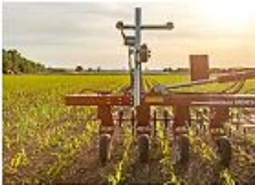
Рис. 2.84 Міжрядний культиватор HORSCH Transformer VF: а – робоче положення; б – транспортне положення; в – прополювання рядків рослин; г – рух робочих органів вздовж рядка за допомогою камери Culticam; д – камера Culticam з освітленням
