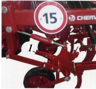
Рис. 4.3.59. Переобладнання культиватора в транспортне положення: 1 – упор
