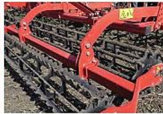
Рис. 2.22. Культиватор КПО-8 «Червонец»: а – загальний вигляд культиватора; б – робота культиватора; в – S-подібні пружинні стійки культиватора; г – робочі органи; д – подвійні зубчасті котки
