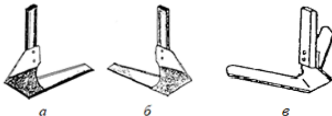
Рис. 3.1 Плоскорізьні прополювальні лапи: а – одностороння правостороння; б – одностороння лівостороння; в – спарені лапи
