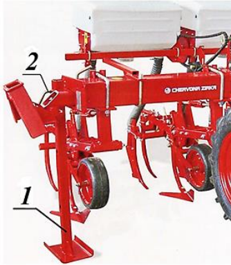
Рис. 4.3.57. Переобладнання культиватора в транспортне положення: 1 – опора; 2 – штир-фіксатор
