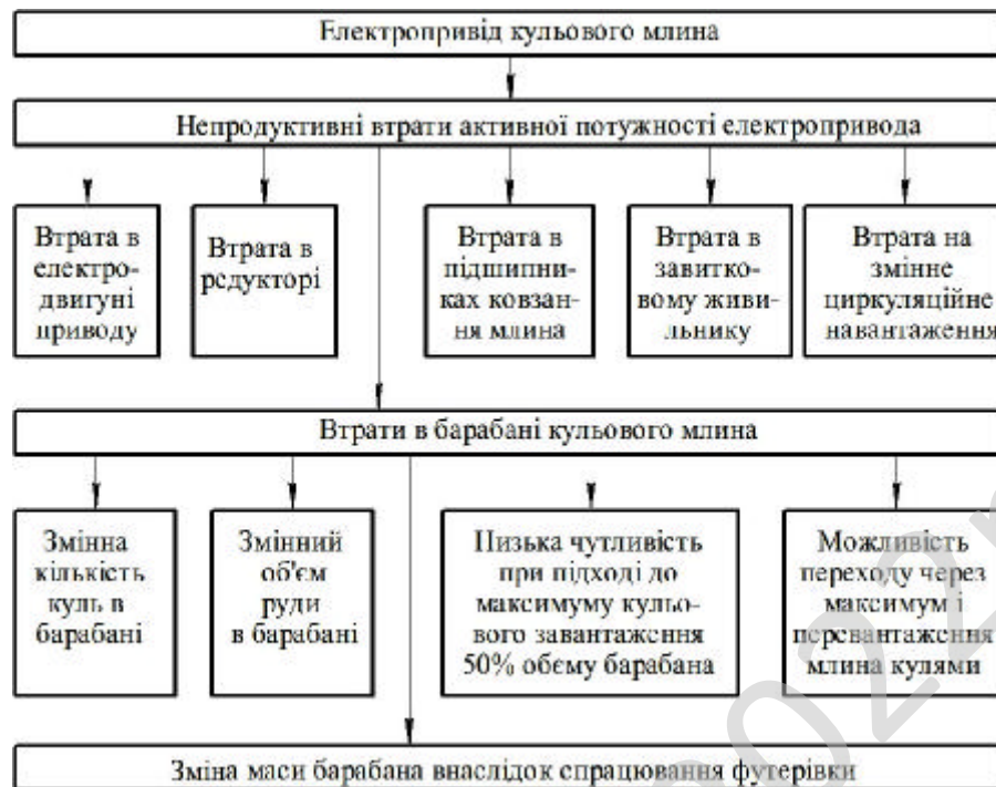
Рисунок 2.1 – Структура непродуктивних втрат активної потужності електроприводом кульового млина
