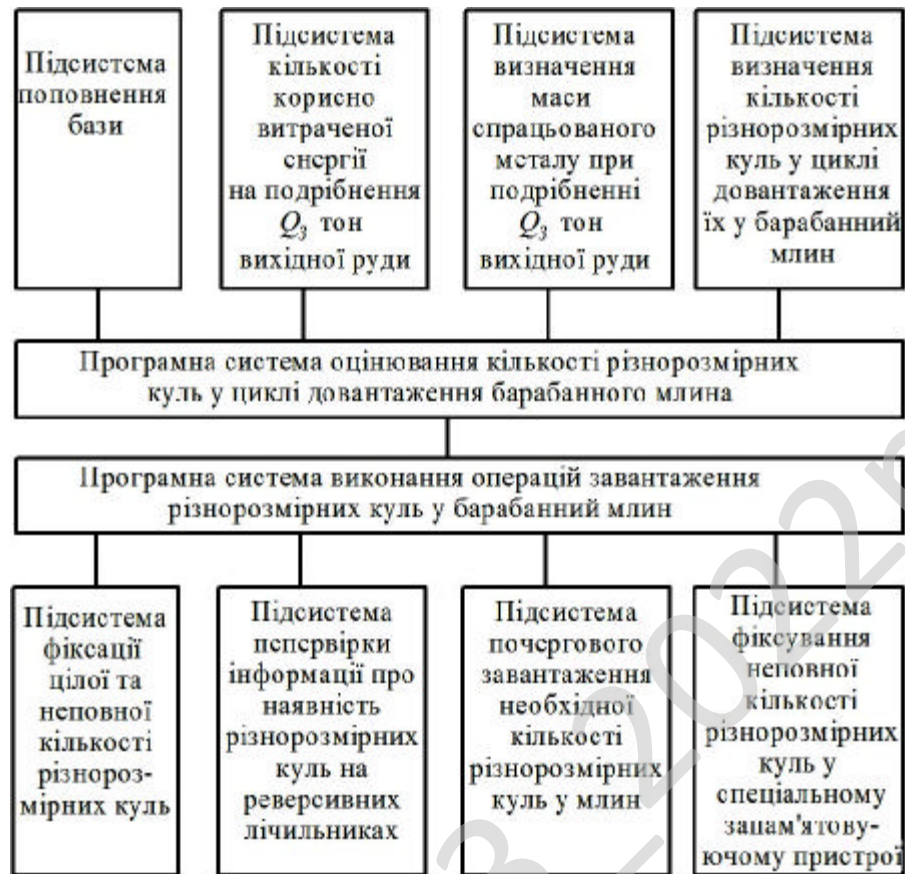
Рисунок 3.4 – Функціональна схема системи стабілізації оптимального різнорозмірного кульового завантаження барабанного млина
