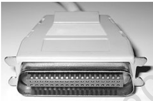
Рисунок 1.2 – Кабельний 36-роз'єм Centronics для підключення зовнішнього пристрою (IEEE 1284-B)
