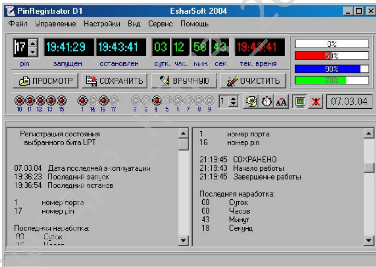
Рисунок 2.3 – PinRegistrator, програма для спостереження й реєстрації логічного стану бітів LPT-порту
