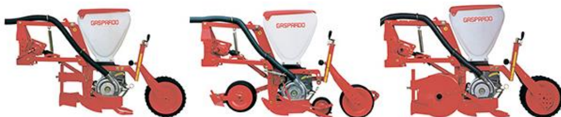
Рис. 2.6. Посівні секції сівалки марки Gaspardo SP-8 з додатковими робочими елементами
