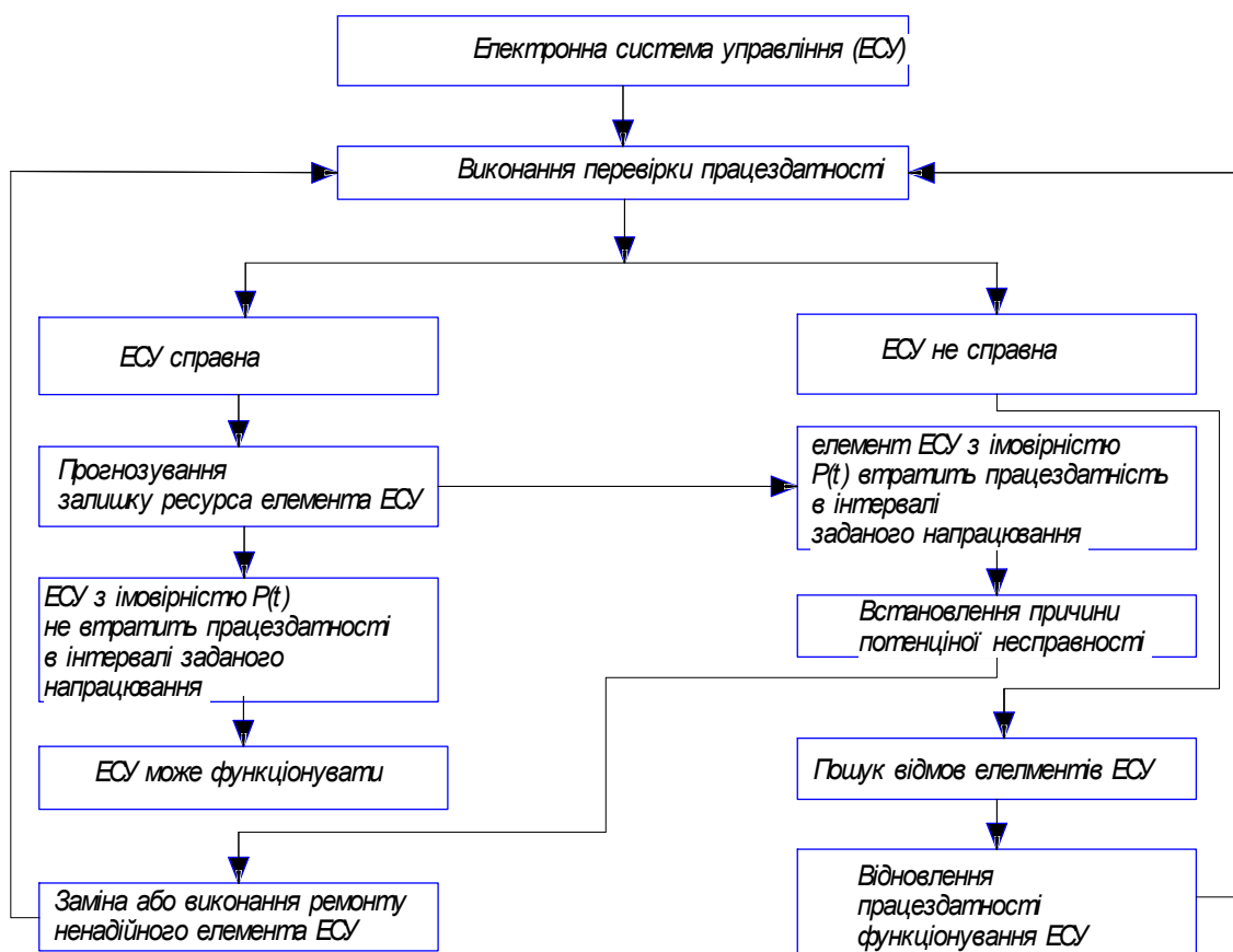
Рисунок 1 - Схема діагностування ЕСУ з проведенням прогнозування надійності елементів Джерело: розроблено авторами
