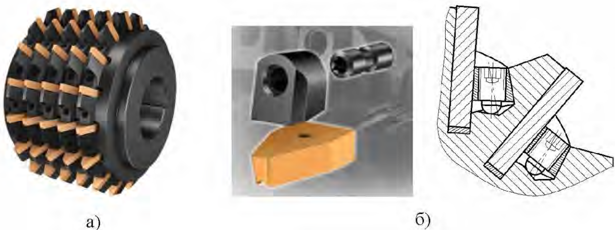
Рис. 1.3 Збірна черв'ячна фреза із вставними зубцями
