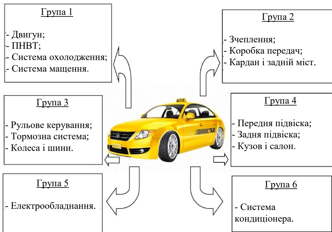
Рисунок 2.9 - Формування груп агрегатів і систем автомобіля-таксі за конструктивними ознаками
