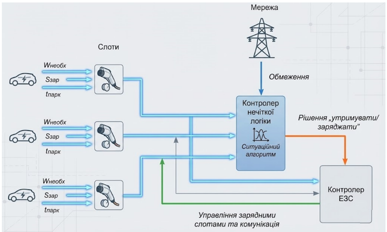
Рис. 2.3. Структурна схема запропонованої системи керування ЕЗС
