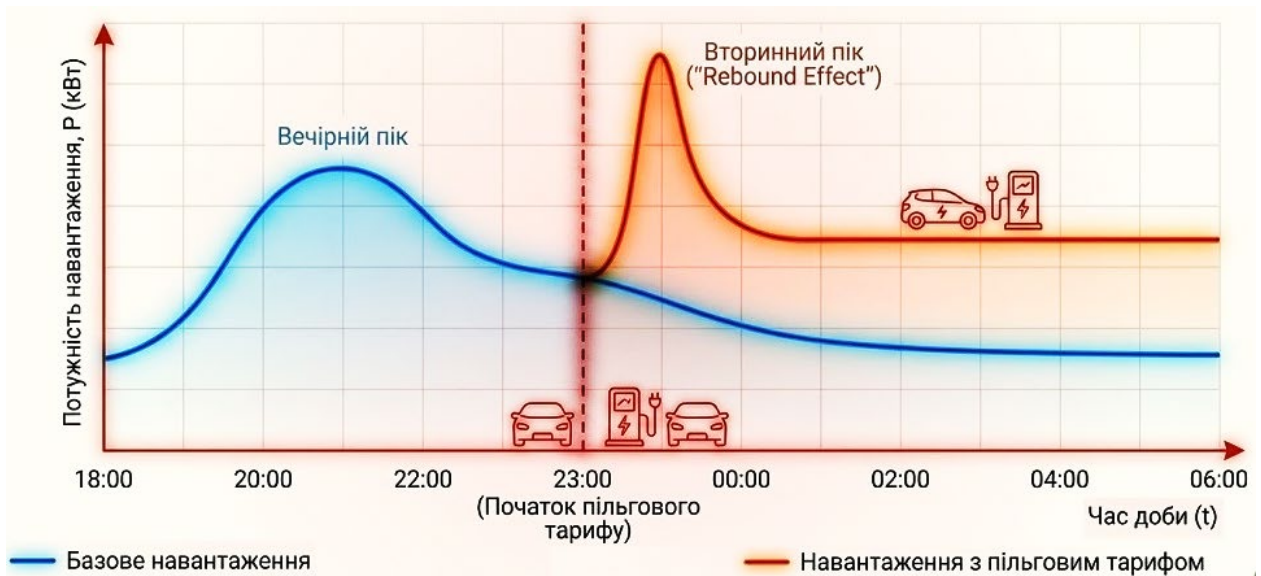
Рис. 1.6. Формування вторинного піку навантаження ("Rebound Effect") при переході на пільговий тариф
