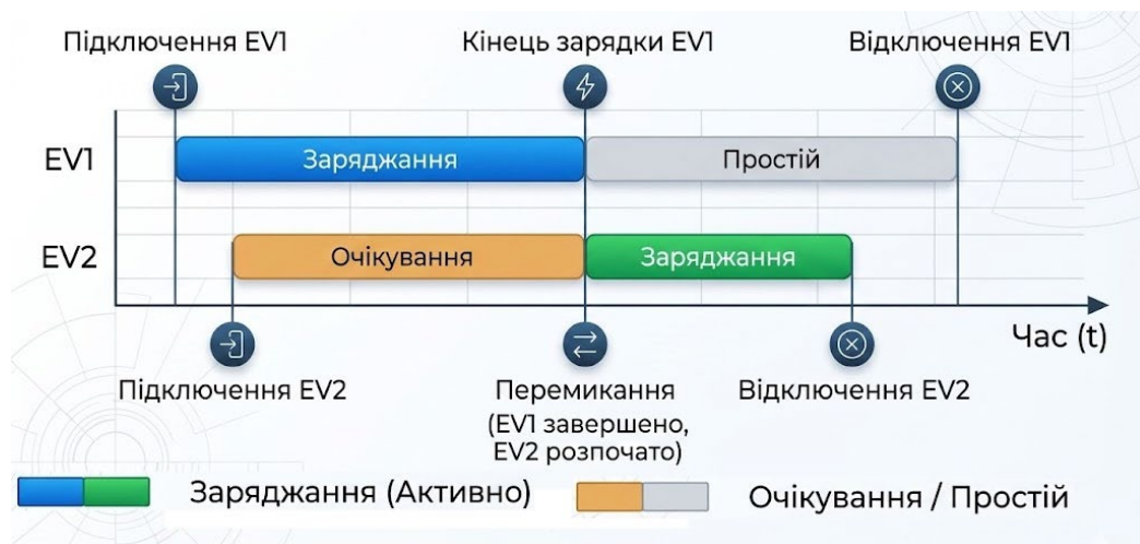
Рис. 1.4. Часова діаграма розподілу енергії при некерованому методі (FCFS)
