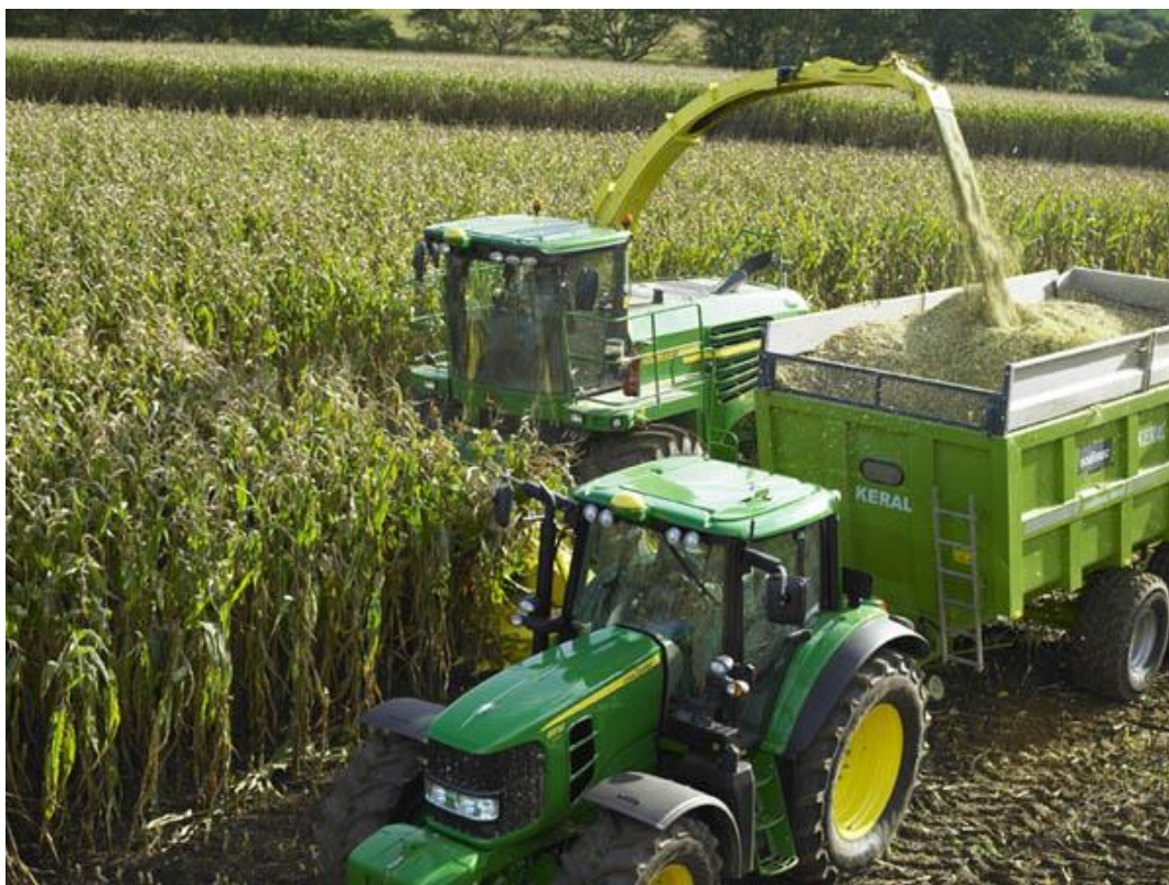
Рис. 3.3. Процес збирання силосної кукурудзи імпортним комбайном John Deere 7350
