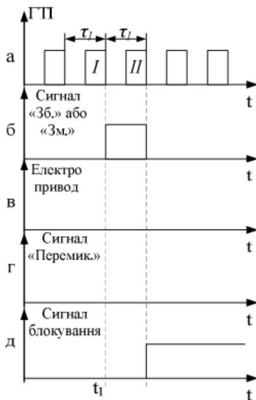
Рисунок 2.14 - Діаграма сигналів управління регулятора напруги при несправності електроприводу РПН
