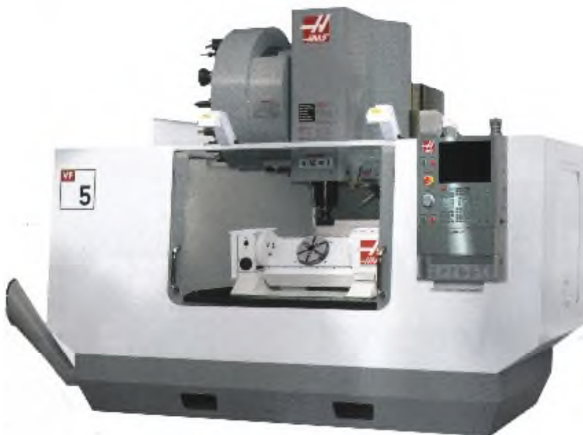
Рис. 7.16. Приклад встановлення нахилено-поворотного столу на обробний центр VF-5 HAAS
