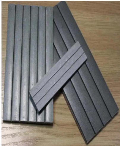
Рисунок 2.6 – Загальний вигляд та характеристики алмазних брусків
