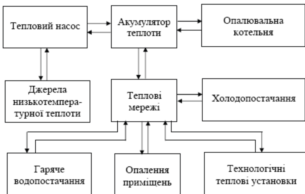
Рисунок 4.12. - Схема опалювальної системи з тепловими Помпами
