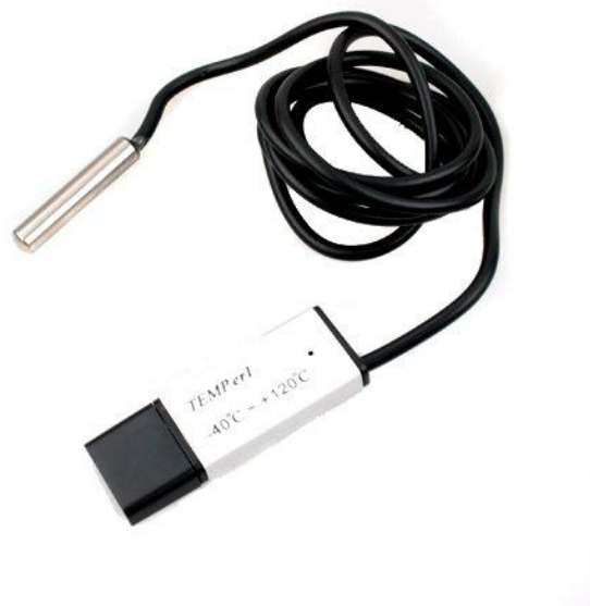
Рис. 4.19. Електронний термометр, яким проводили вимірювання температури
