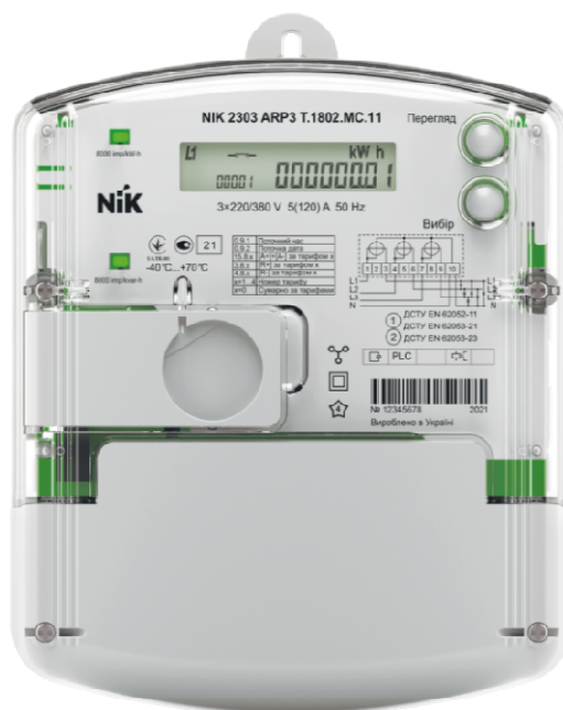
Рисунок 7.3 – Зовнішній вигляд лічильника NIK 2303
