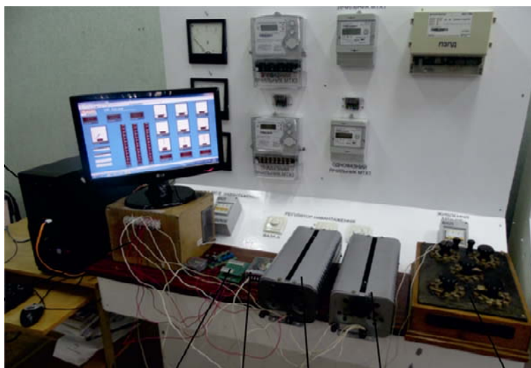
Рисунок 6 – Загальний вигляд лабораторного стану для експериментального дослідження САУ блоку управління рівнем генерації активної потужності в КЕЕС з ВДЕ
