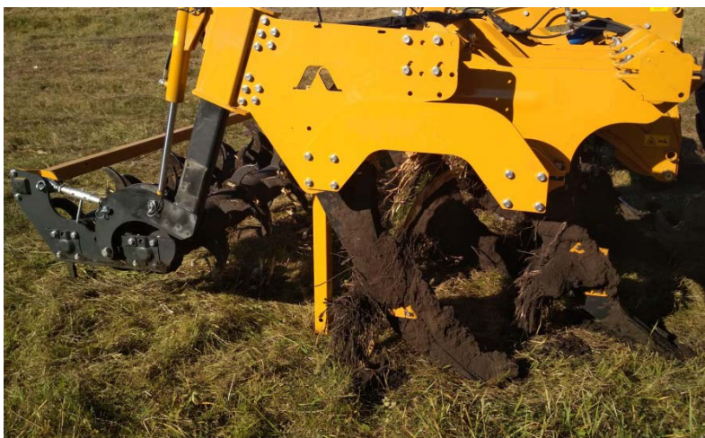
Рисунок 1 – Налипання ґрунту на поверхню розпушувача
