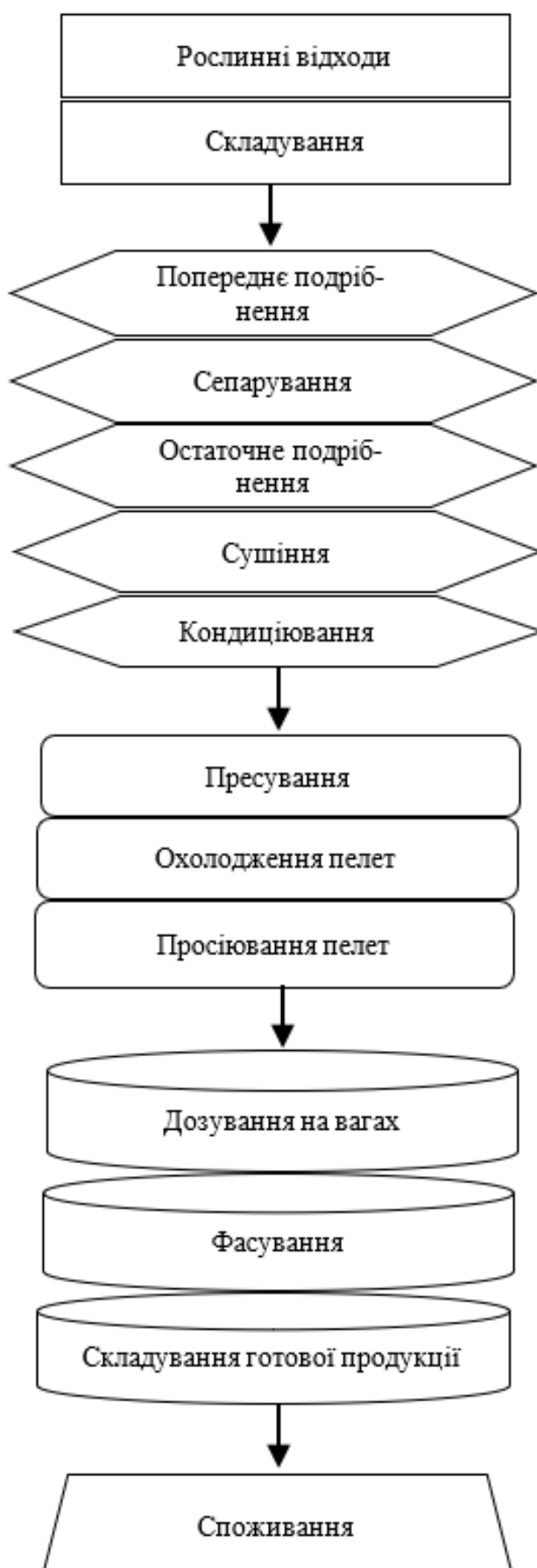
Рисунок 1.5 – Технологічна послідовність виготовлення пелет з рослинних відходів
