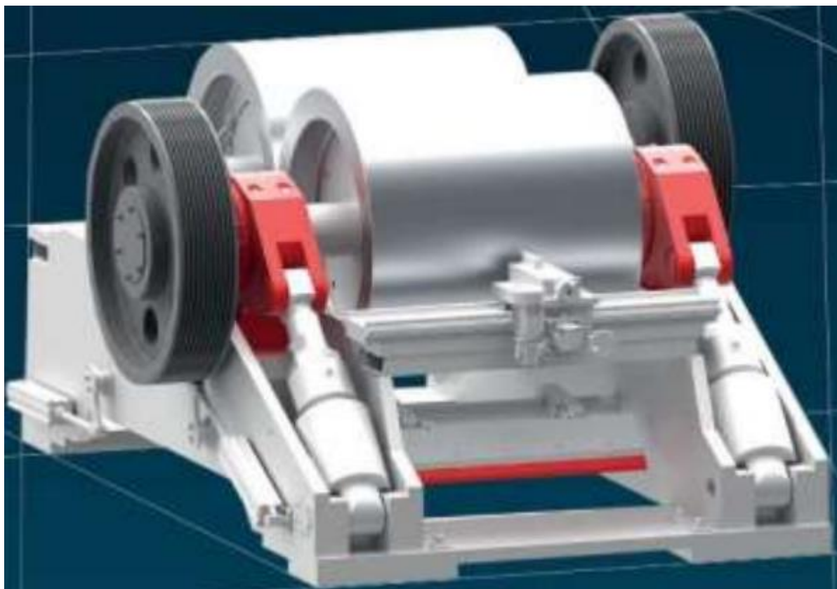
Рисунок 3.1 - Дробарка двовалкова зубчаста СМД - 175А зі знятим кожухом
