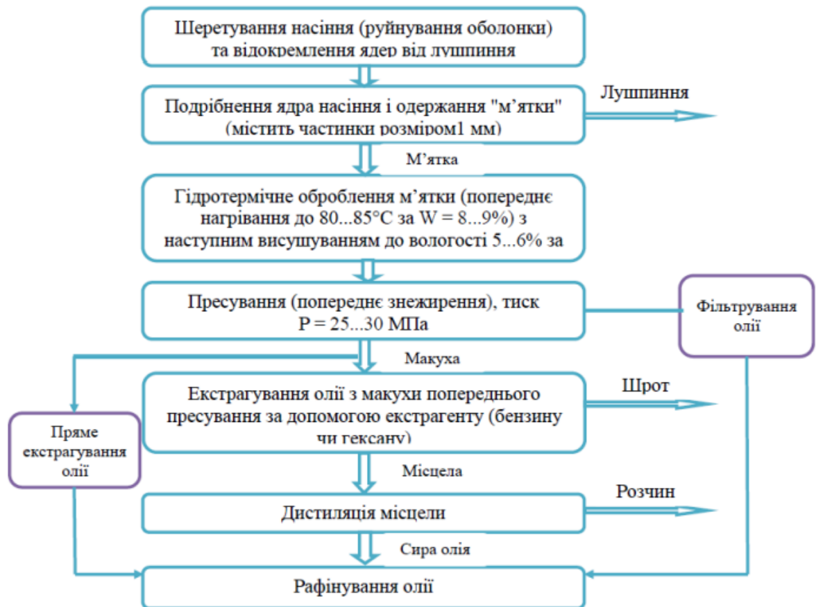
Рис. 4.1 – Основна технологічна схема одержання олії [8].
