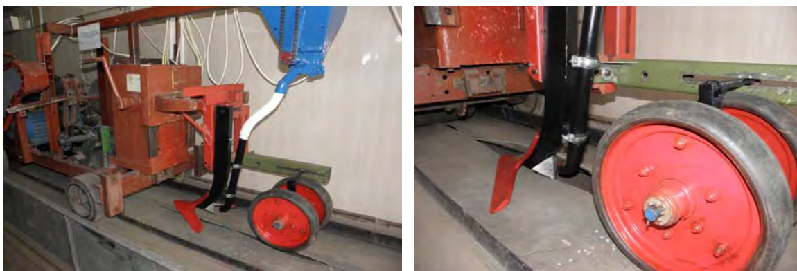
Рисунок 2 – Загальний вигляд експериментальної установки в ґрунтовому каналі
