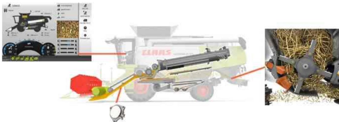
Рис. 2.14. Загальна схема системи подрібнення соломи CEMOS AUTO CHOPPING
