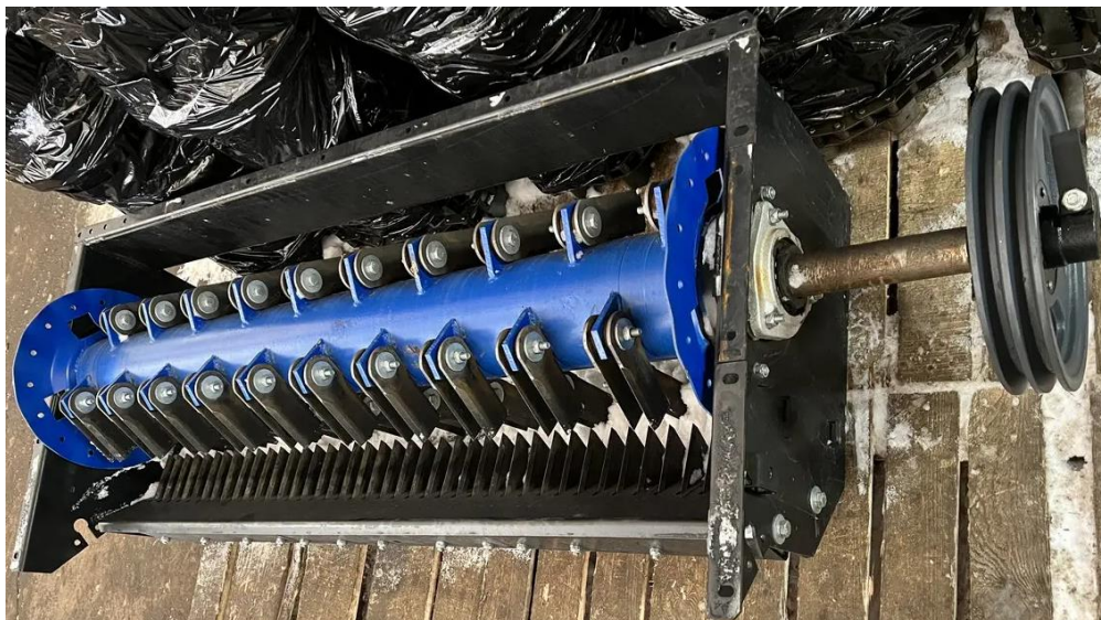
Рис. 2.5. Подрібнювач соломи комбайна КЗС–9 Славутич [5]
