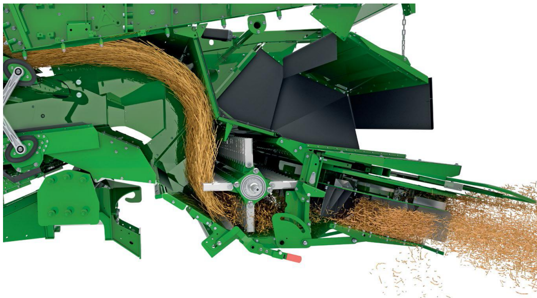
Рис. 2.8. Схема подрібнення та виведення соломи з комбайна
