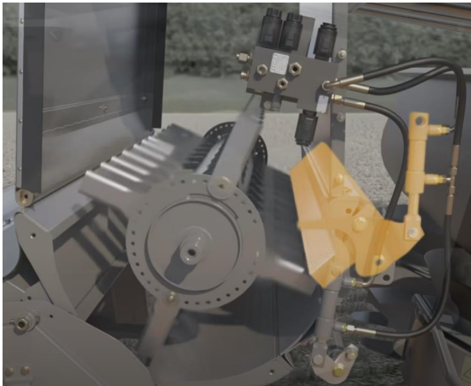
Рис. 2.13. Подрібнювач соломи системи SPECIAL CUT II з гідросистемою його керування
