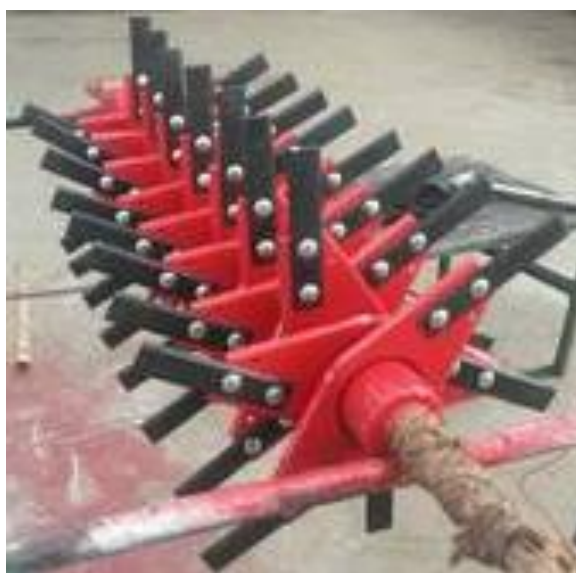
Рис. 2.2. Ротор подрібнювача соломи ПУН-5
