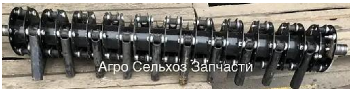
Рис. 2.3. Ротор подрібнювача соломи комбайна Дон–1500
