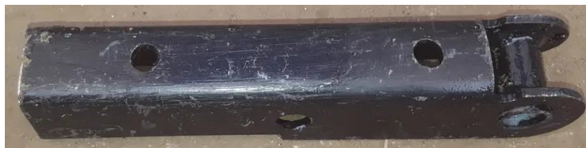
Рис. 2.4. Ніж подрібнювача соломи комбайна Дон–1500
