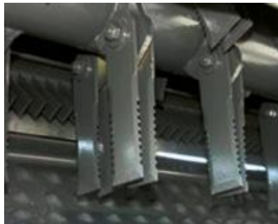
Рис. 2.15. Система подрібнення соломи CEMOS AUTO CHOPPING
