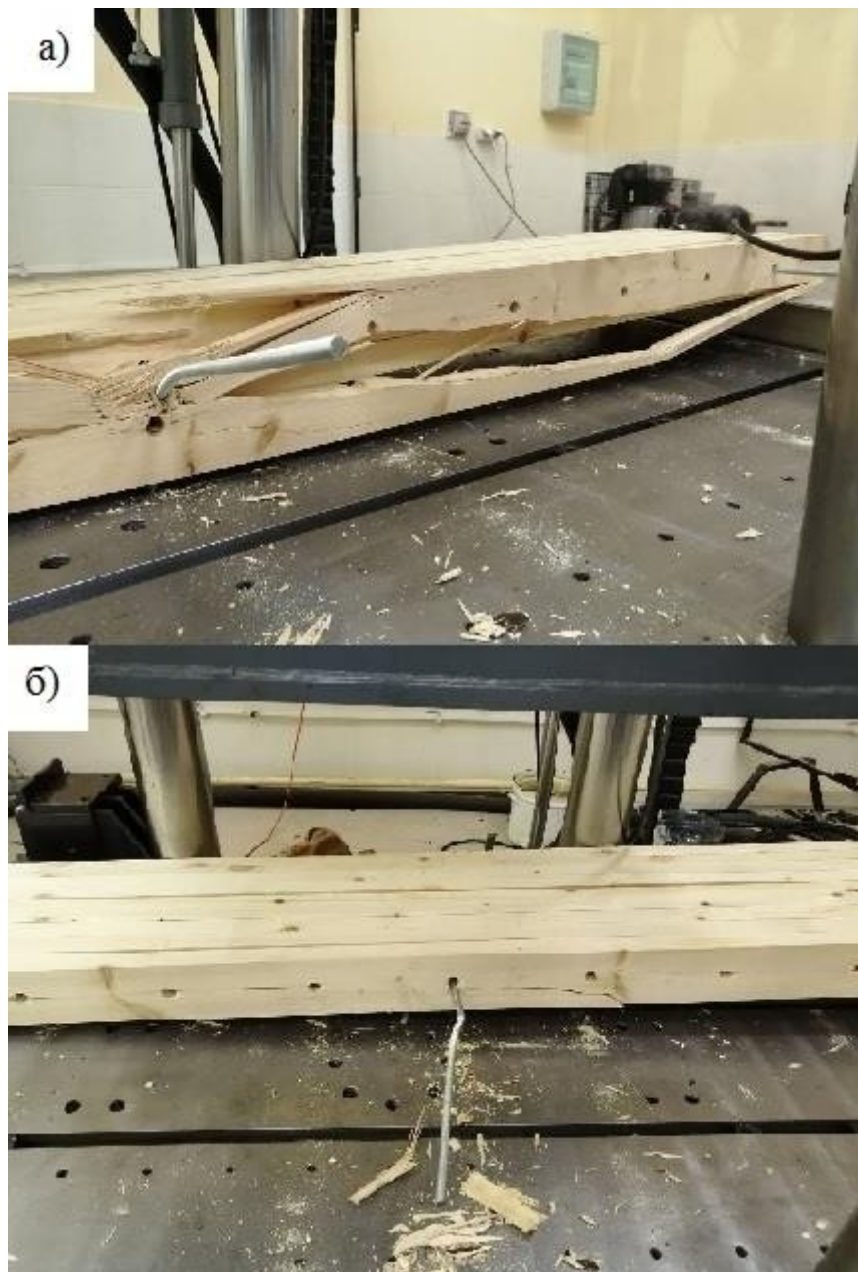
Рисунок 17. Руйнування зразка: а) тріщина в центральному елементі (навантаженому) б) тріщина в елементі на границі частини перетину.
