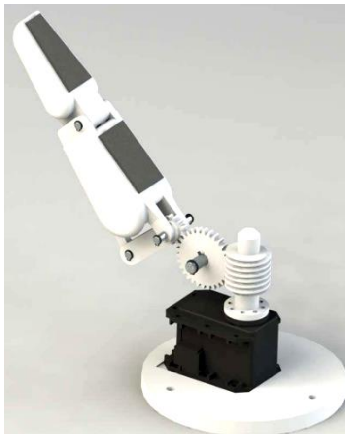
Рис.2.10. 3Д модель пальця з приводом та червячною передачею
