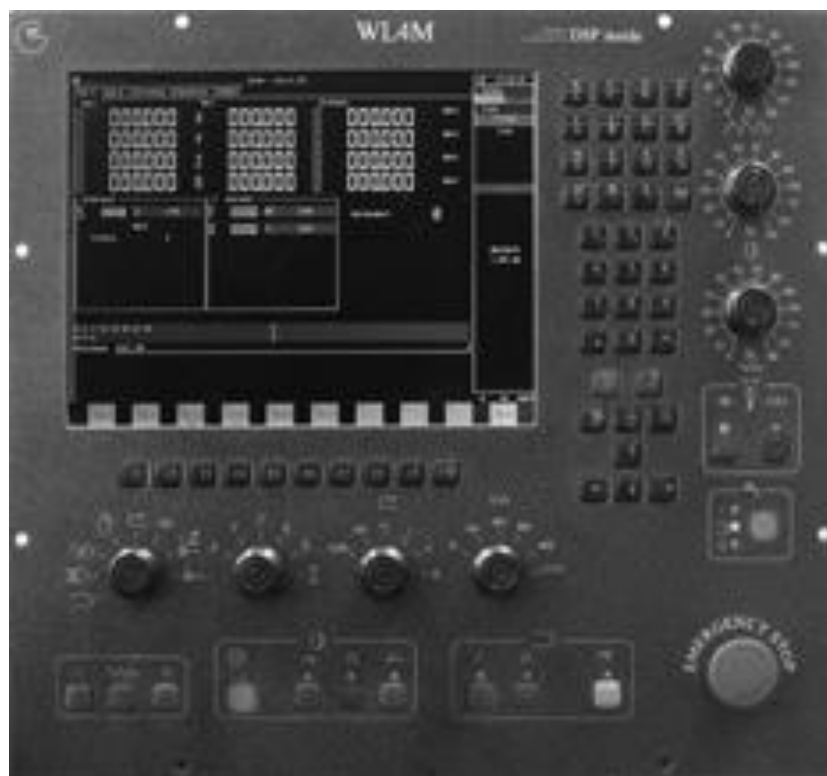
Рис. 2.7. WL4M – СЧПУ для верстатів фрезерної групи (Україна, м. Харків)
