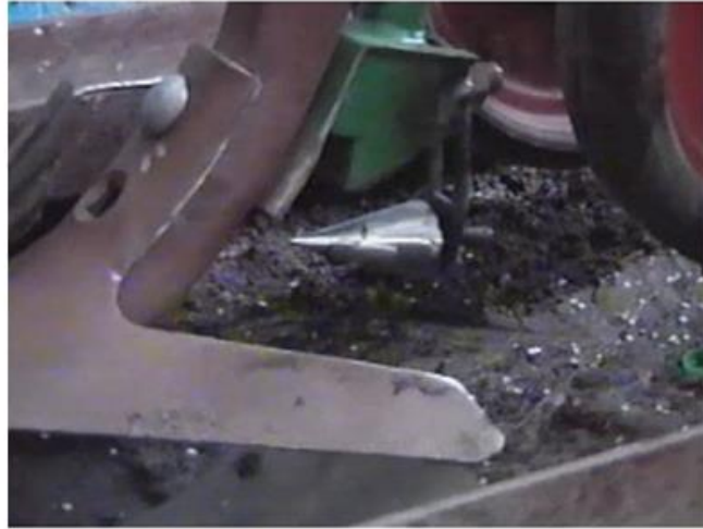
Рис. 3.8. Серійна лапа комбінованого агрегату з конусним розподільником
