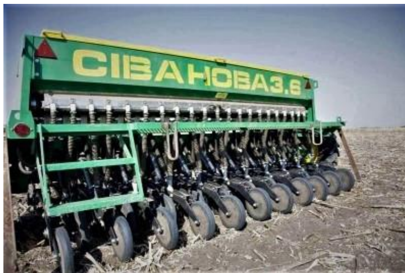
Рис. 3. Сівалка зернотукова прямого посіву «Сіва Нова» 3.6
