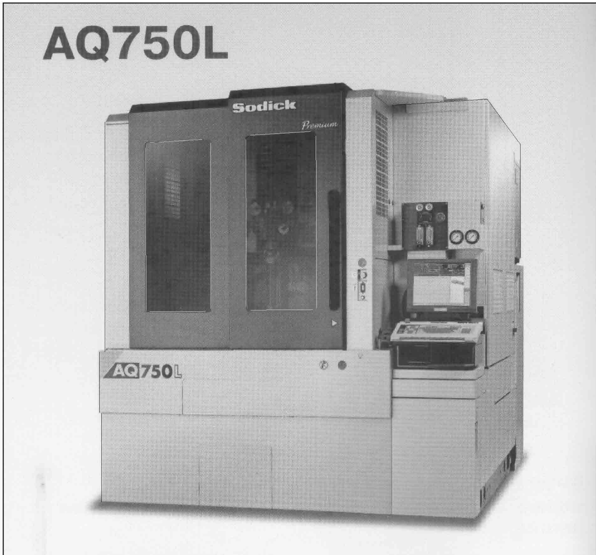
Рис. 1.2. Прецизійний дрото-вирізний електроіскровий верстат моделі AQ750L фірми Sodick
