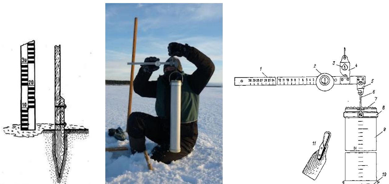
Рис. 1.3 Снігомірна рейка, ваговий снігомір та робота з ним
