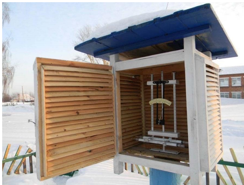
Рис. 1.4 Психрометрична будка та встановлений у ній комплект термометрів
