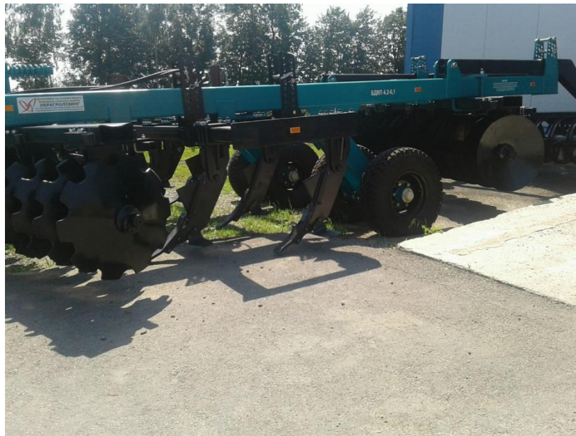
Рисунок 2.10 – Борона диско-чизельна БДВП-3,0-01 виробництва ТОВ “АГРОМАШ” КРАСНЯНСЬКЕ СП [12]
