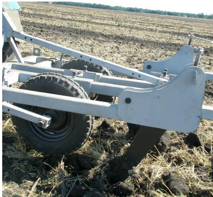
Рисунок 3.2 – Загальний вигляд виготовленого для експериментів чизеля в роботі
