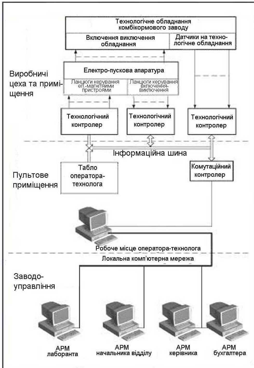
Рис. 4.7. Структурна схема автоматизованого управління комбікормовим заводом
