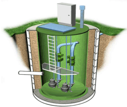
Рисунок 1.2 – Схема каналізаційної насосної станції.
